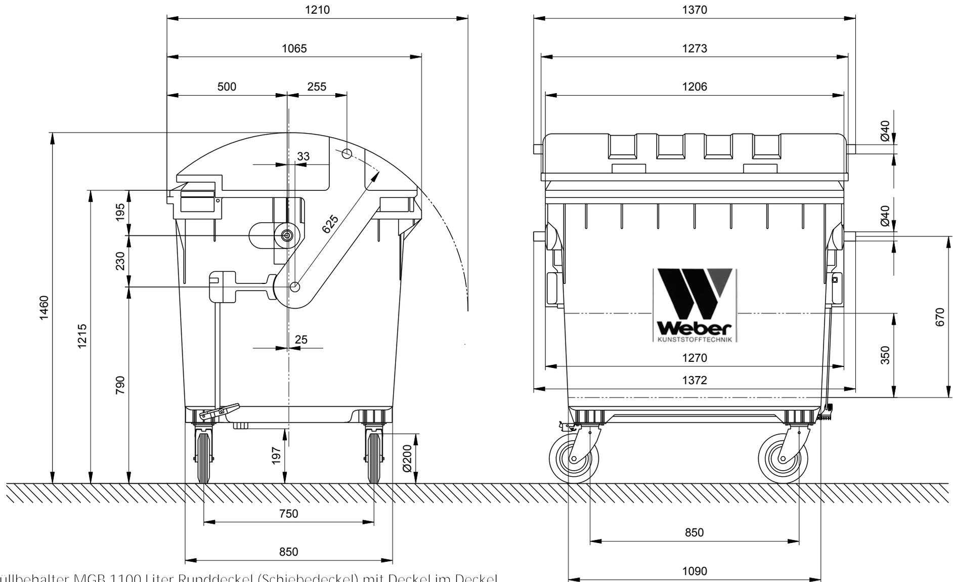
Müllbehälter MGB 1100 Liter Runddeckel (Schiebedeckel) mit Deckel im Deckel
